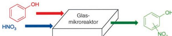
**Miniaturisierung:** Die Nitrierung von Phenol ist als autokatalytische, stark exotherme Reaktion im industriellen Maßstab schwer umzusetzen. Im Mikroreaktor (siehe Bild) gelingt die kontinuierliche Nitrierung sicher und mit höheren Aus-
